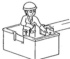
バケット内作業者は墜落防止のために安全帯を着用後、安全帯とクサリを金具に確実に掛けてください。
